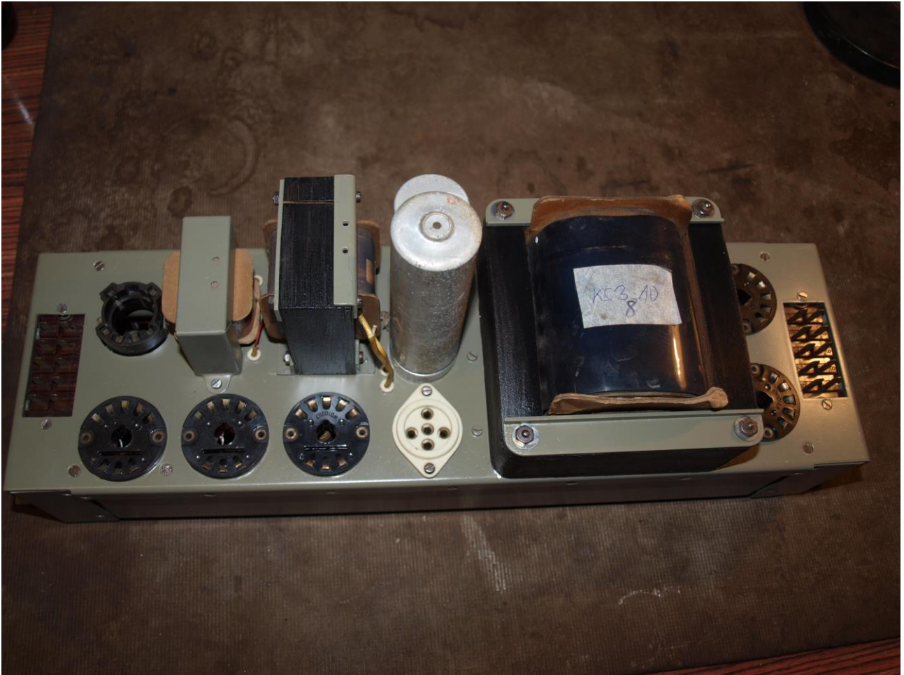
Modul KS3-10 po renovaci
