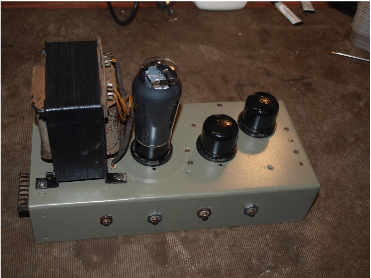
Snímkový rozklad KS1-4 po renovaci
