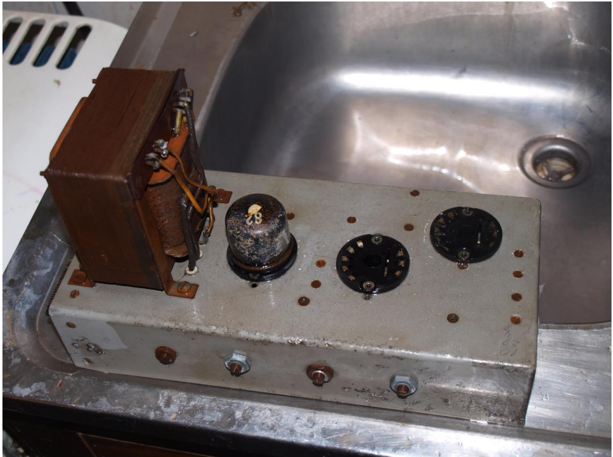
Snímkový rozklad KS2-4 před renovací
