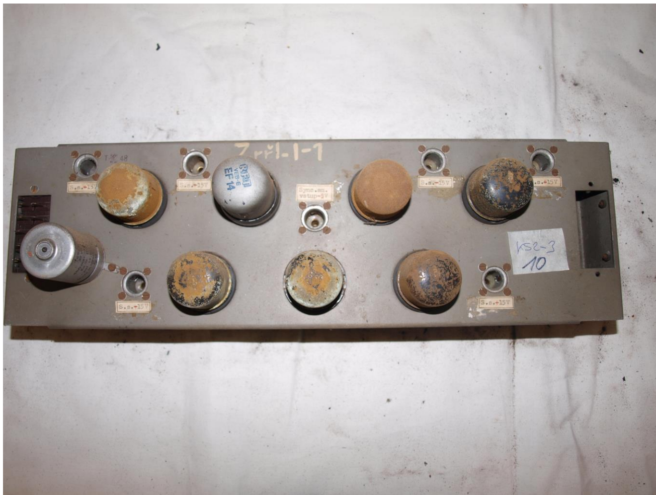
Modul KS2-3 před renovací
