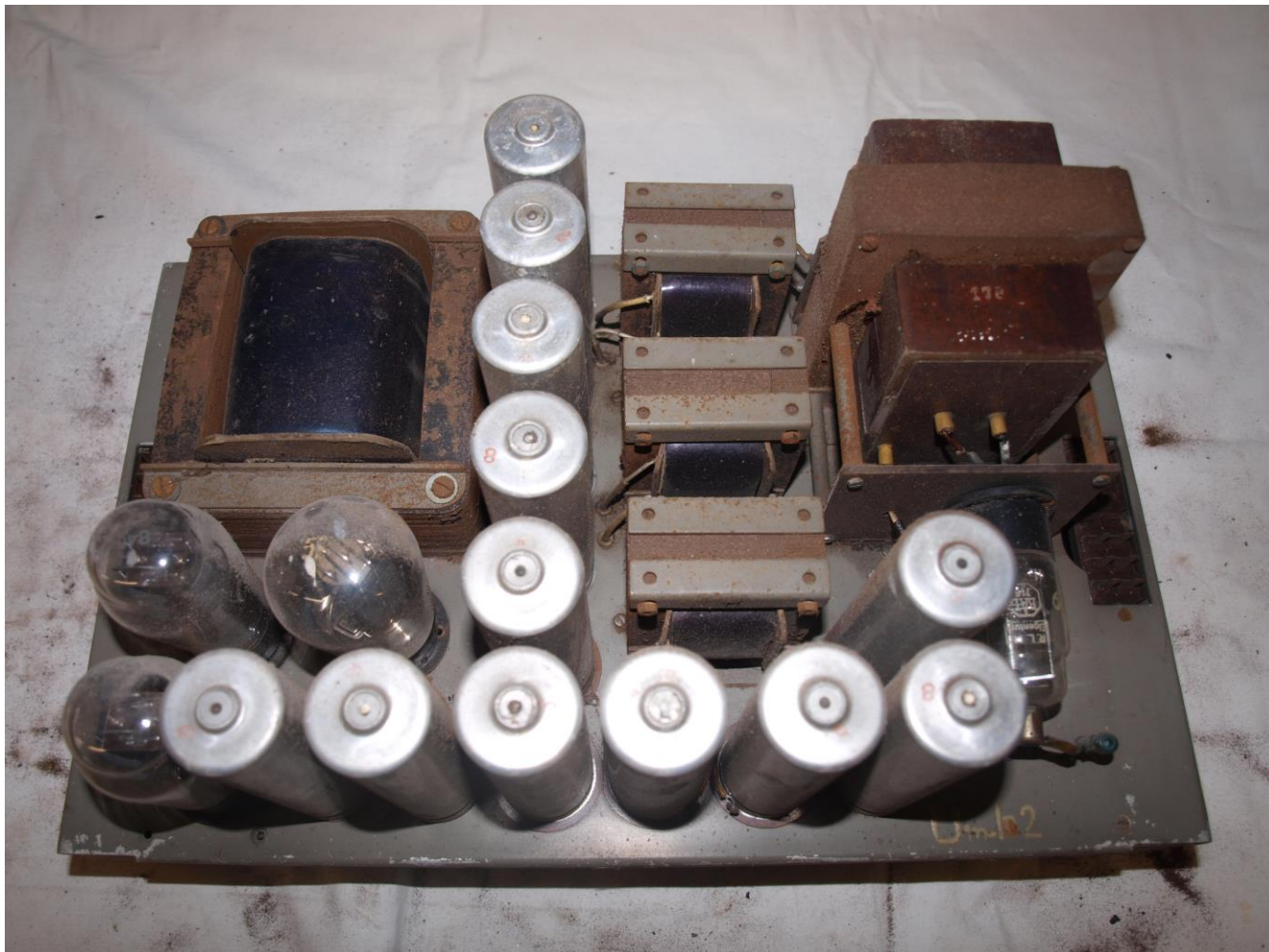
Modul KS3-11 před renovací
