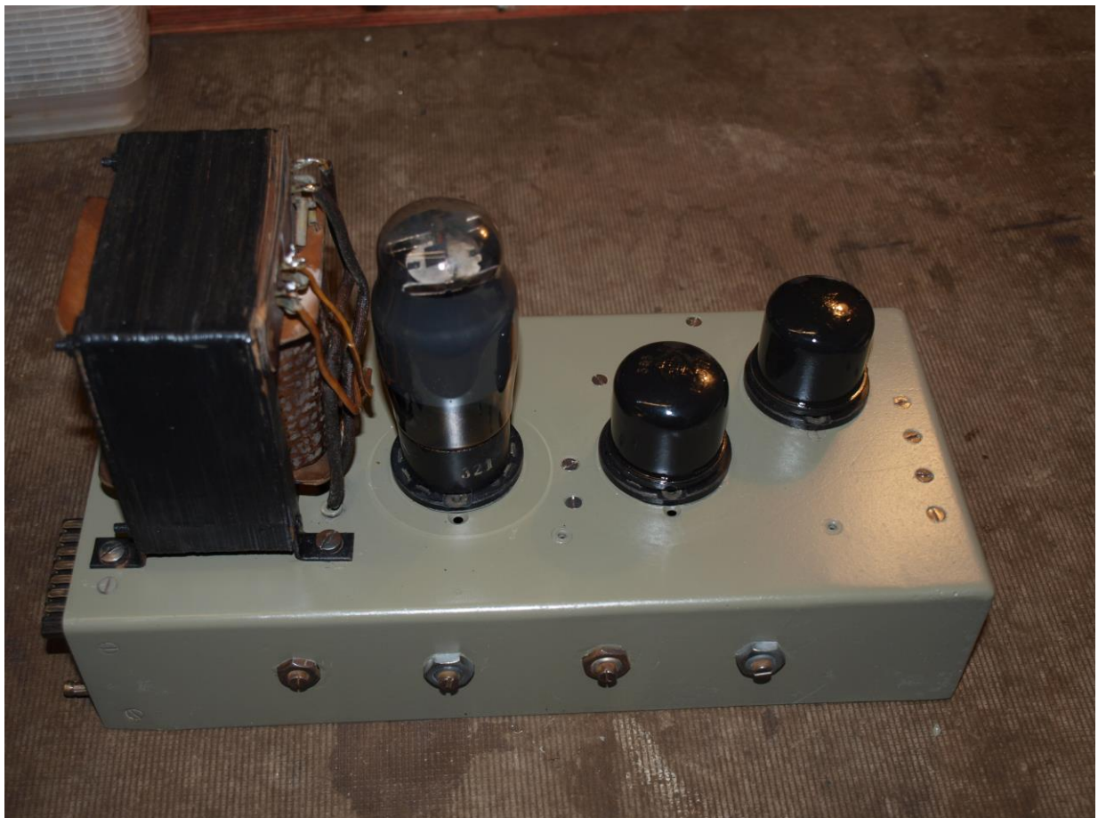
Snímkový rozklad KS2-4 po renovaci
