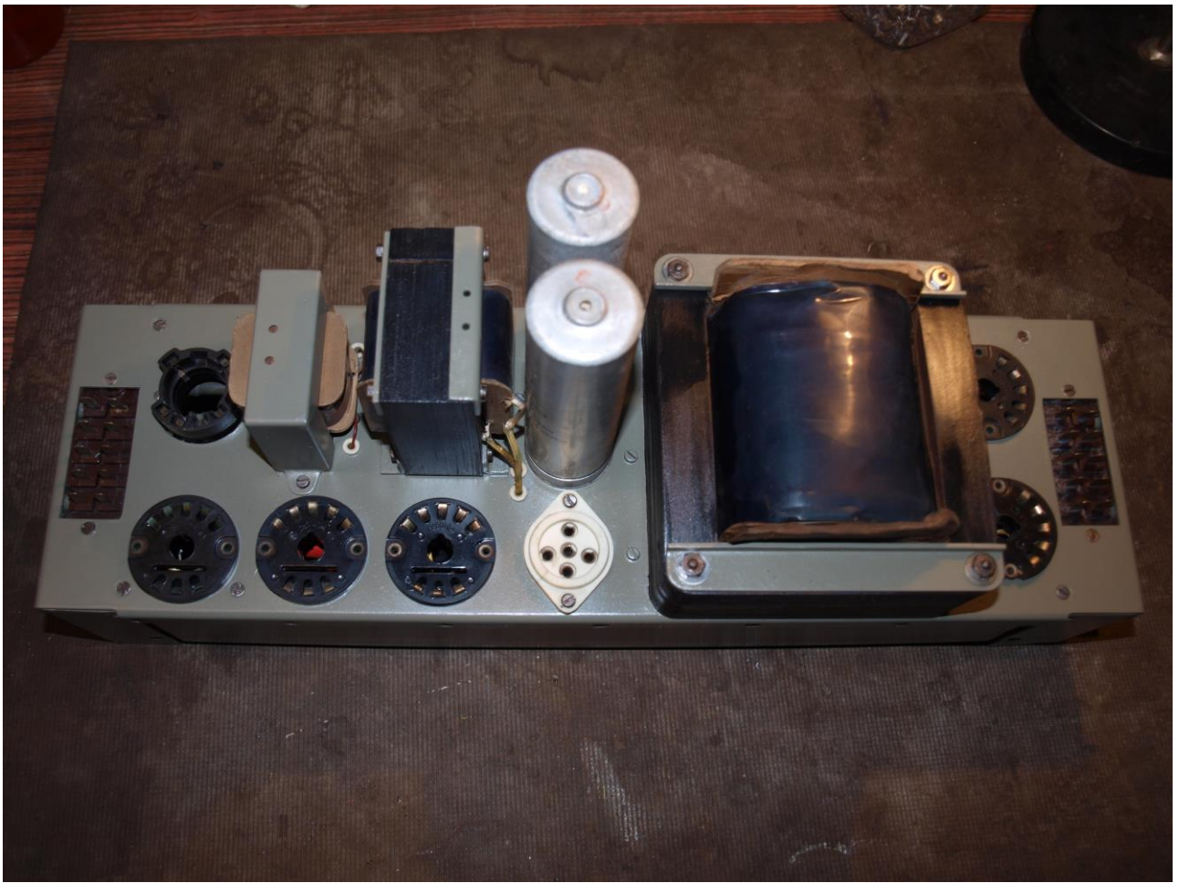
Modul KS1-8 po renovaci
