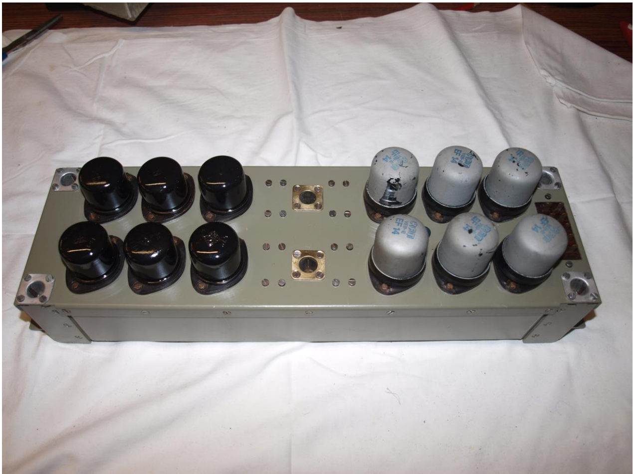
Modul SY2-2, 4 po renovaci. Elektronky uprostřed mají být 4x EL11.
