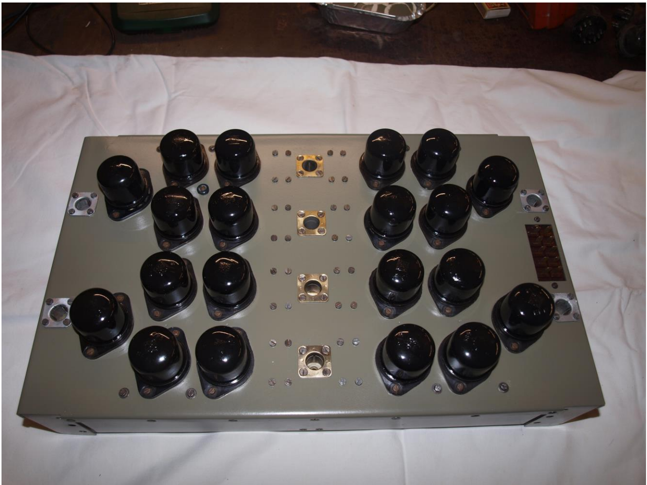
Modul SY2-4, 3 po renovaci. Elektronky uprostřed mají být EL11 (16x).
