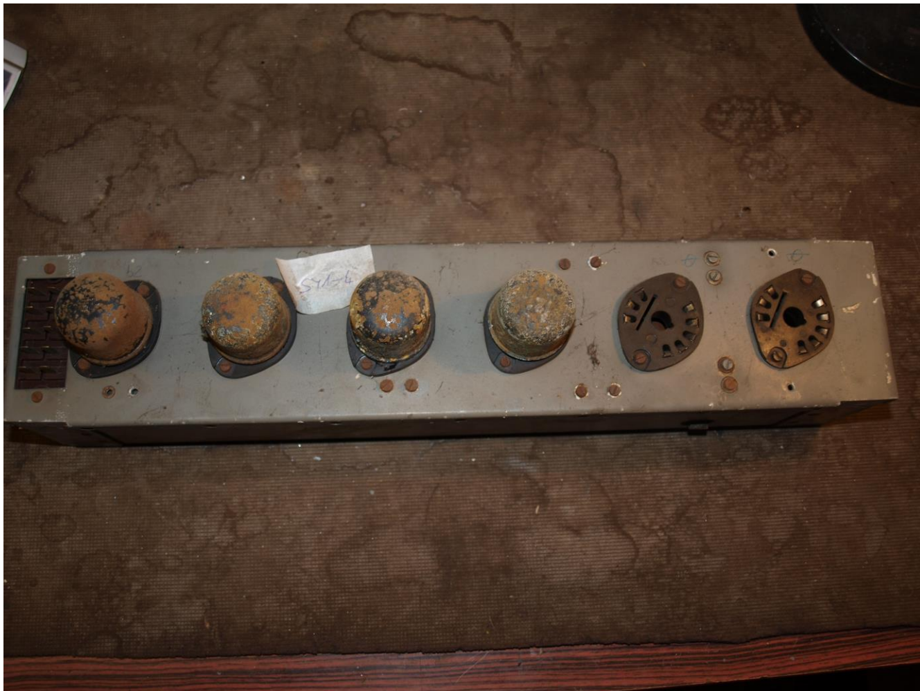
Modul SY1-4, 4P před renovací
