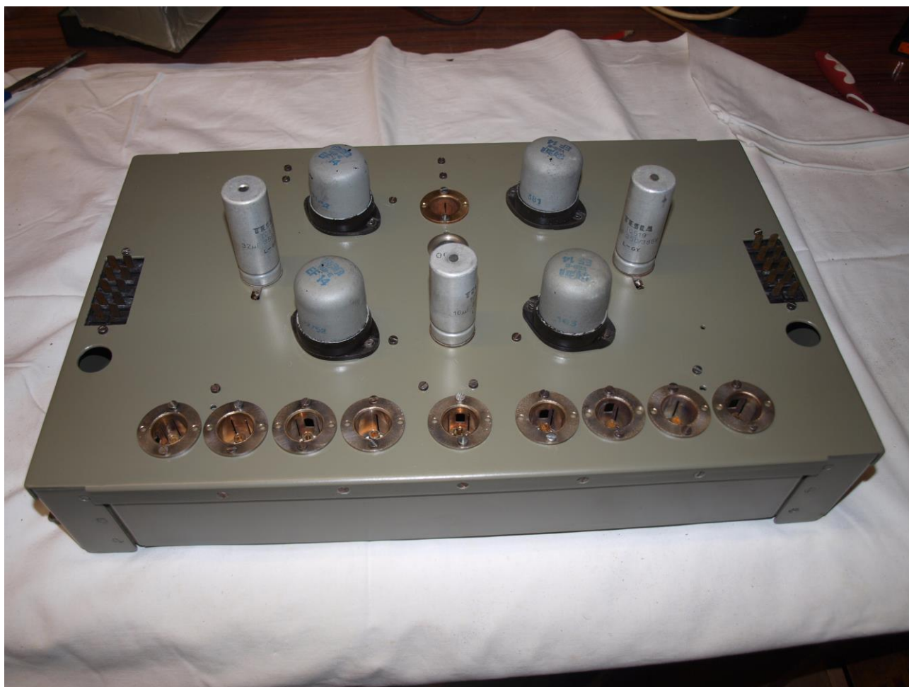
Modul SY2-3, N po renovaci. Elektronky v pravé části mají být EL11.
