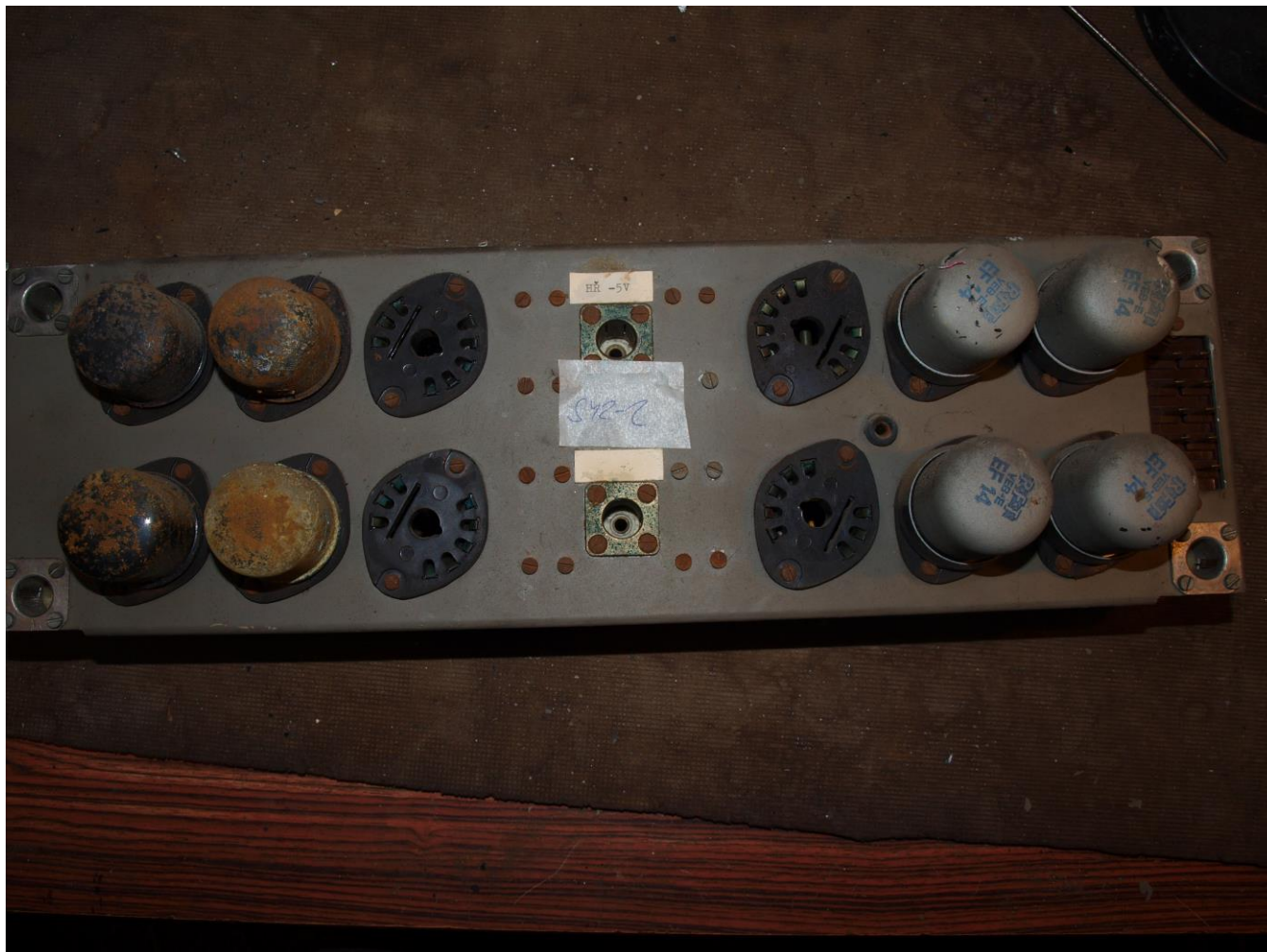
Modul SY2-2, 4 před renovací
