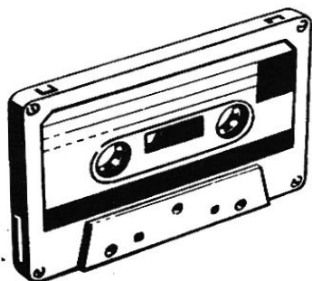
Obr. 3 a) Okénko nevyložené (záznam možný)
